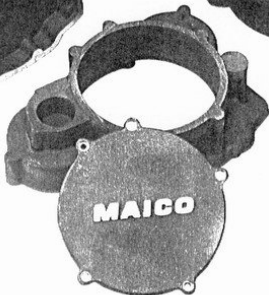
Aluminium gietstukken ter vervaardiging van carter/versnellingsbakken en cilinders
